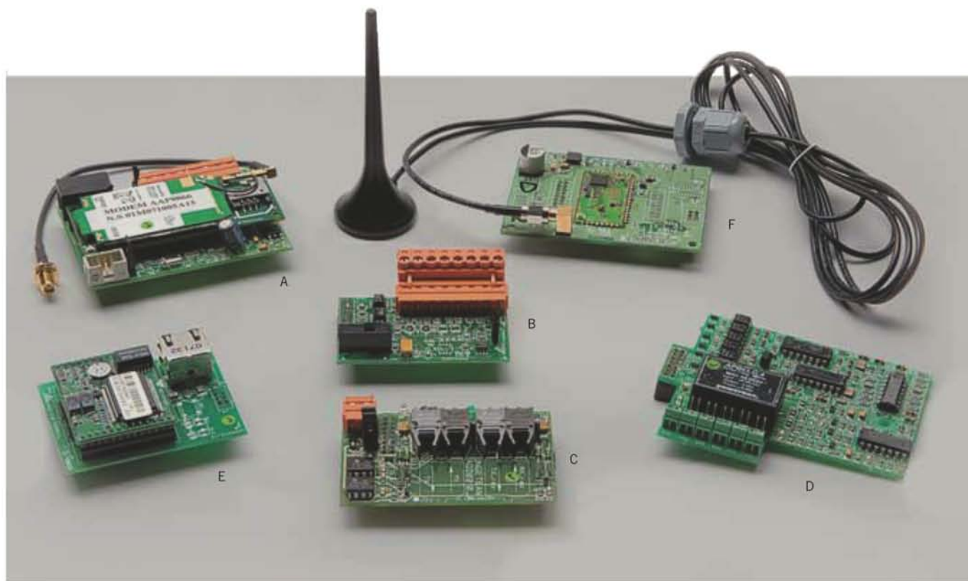
A. Modemová karta pro vzdálenou komunikaci přes síť GSM/GPRS. B. Karta RS-485 pro vzdálenou komunikaci se střídači fotovoltaické elektrárny C. Analogová vstupní karta k záznamu parametrů prostředí (např. teploty, slunečního záření) D. Karta optických vláken E. Ethernetová karta F. Bezdrátová karta ISM868
